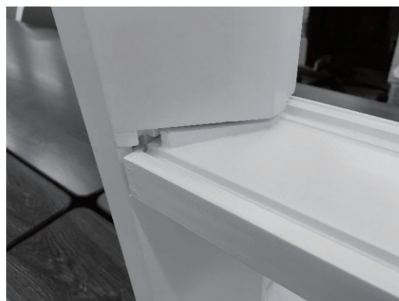
写真-5 底と袖壁の収まり (3D プリンタ)
