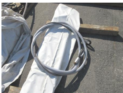
写真-21 荷揚げ用ワイヤー
