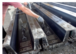
写真-1 ショルダー取り付け 写真-2 スポット溶接
