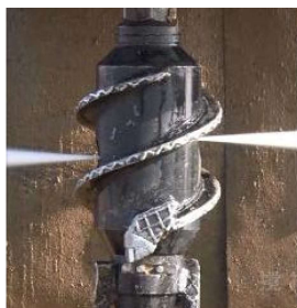
写真-1 攪拌機先端ビット (噴射力=30Mpa)
