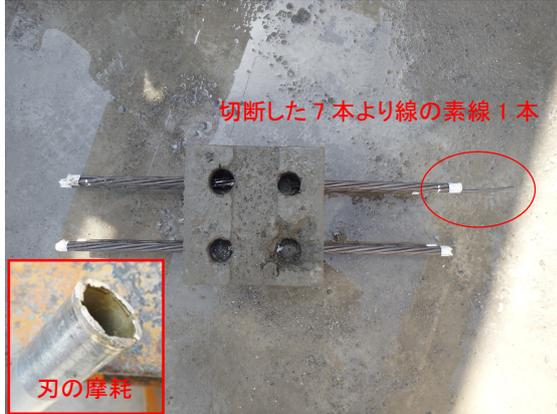
写真-4 コア刃による切断後の状態
