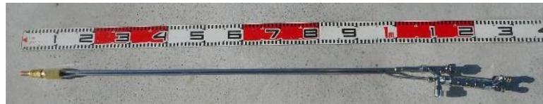
写真-8 ガス切断機(ロングタイプ)
