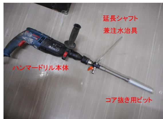
写真-3 コア抜きビット装着ハンマードリル
