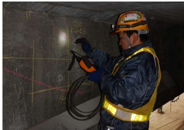
写真-6 CCD カメラによる内部探索状況
