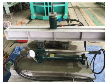
写真-7 引抜試験状況
