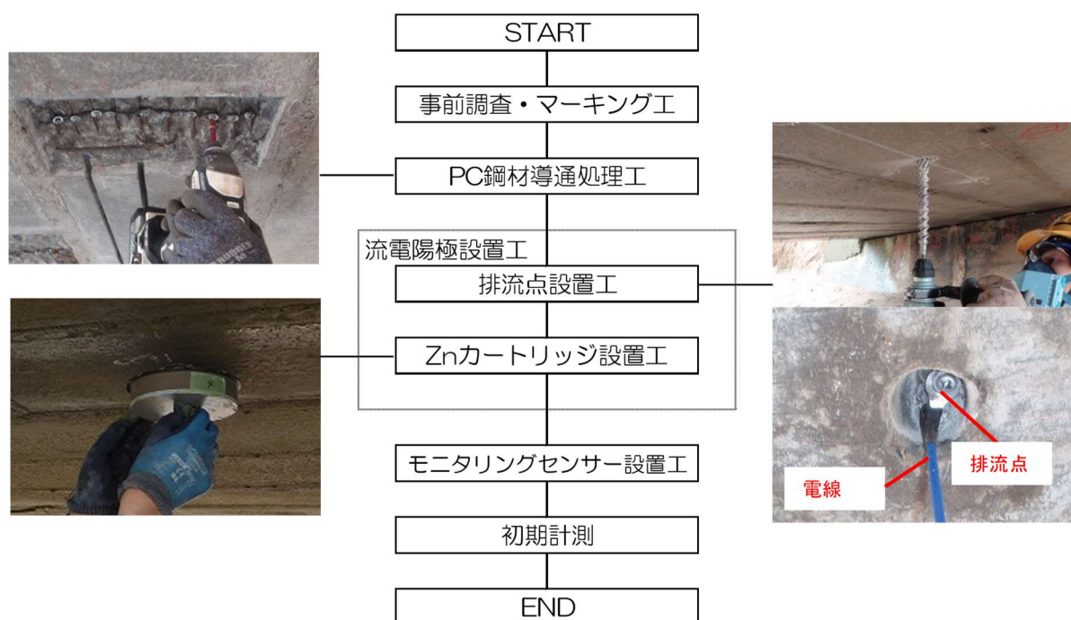
図-5 表面設置タイプの施工フロー
