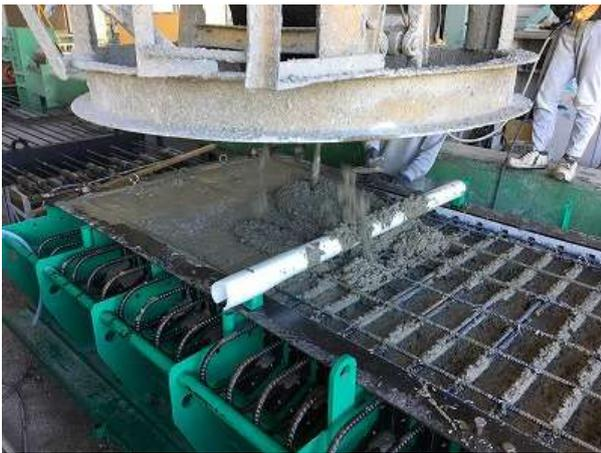
写真-2 コンクリート打設状況
