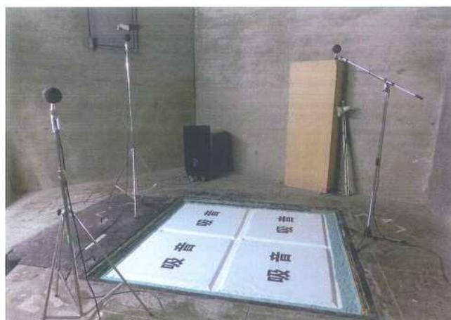
写真-2 音響透過損失試験状況
