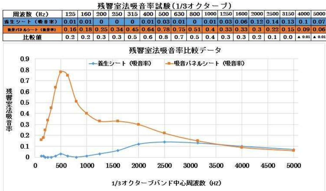
図-3 残響室法吸音率試験結果
