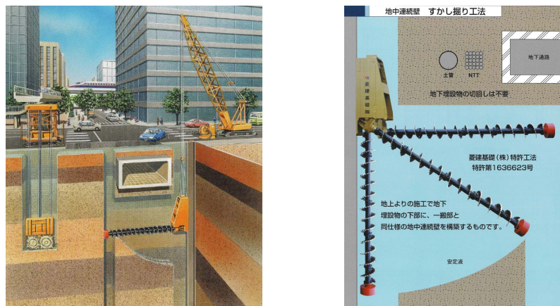
図-4 地中連続壁・すかし掘り工法 イメージ図
