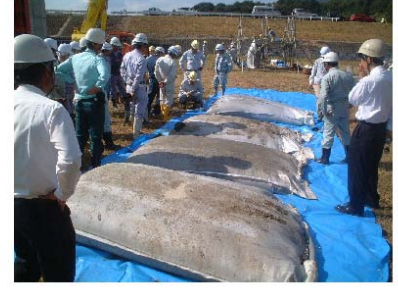
写真-3 充填土嚢試験体
