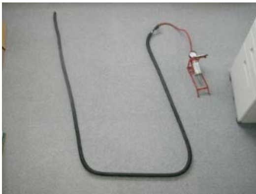
写真-16 ゴムチューブ目地型枠
