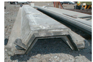
写真-1 打設後先端の状況
