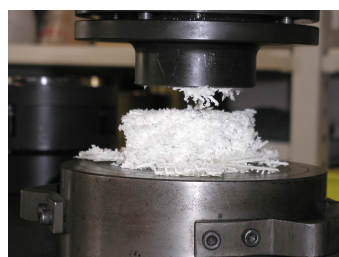
歪み80%載荷後ヘッドを上げた状況
