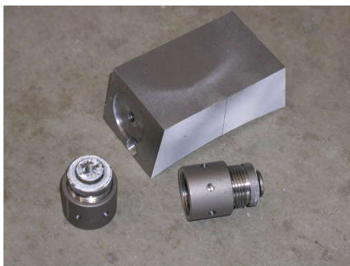
写真-3 円柱供試体の定着具
