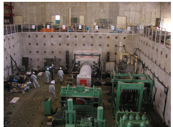
写真-1 正負交番載荷試験試験の装置
