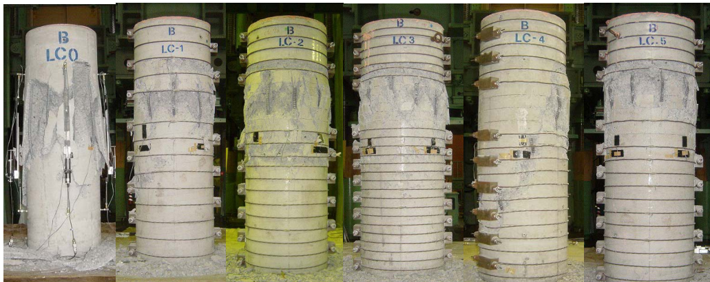
写真-6 最終損傷状況(円柱供試体:左から LC0 ~ LC5)
