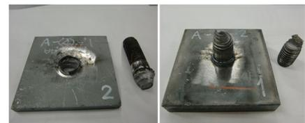
写真-1 引張試験での破壊状況
