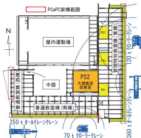
図-2 PCa 部材配置、架設重機
