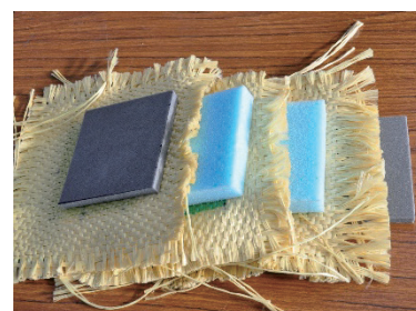
写真-2 緊張防護板内部構造
