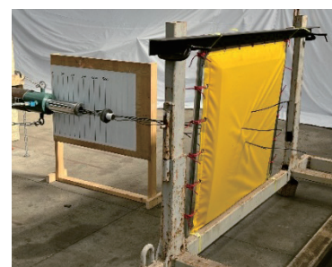
写真-4 PC 鋼線破断後の緊張防護板
