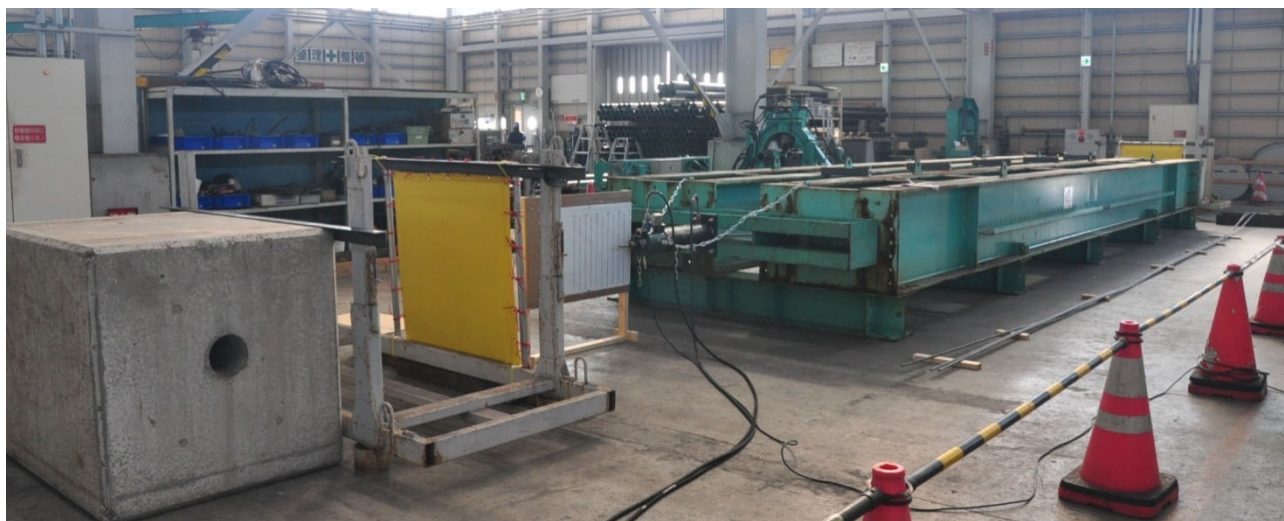
写真-3 PC 鋼線破断試験緊張装置全景
