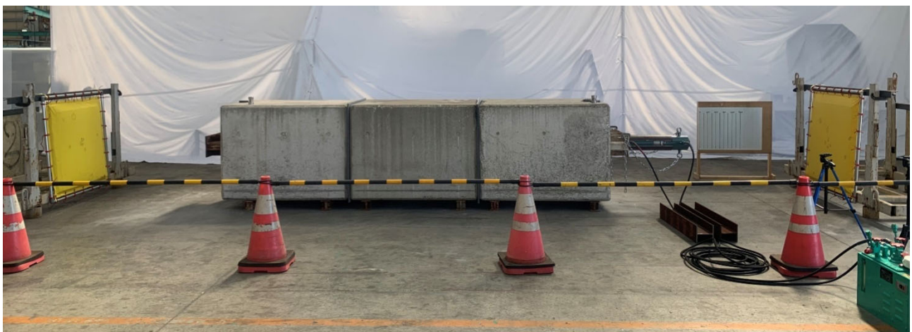
写真-6 PC 鋼線破断試験緊張装置全景
