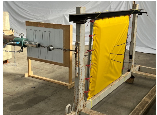
写真-8 PC 鋼線破断状況 4
