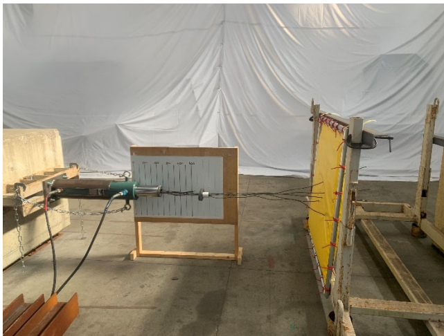
写真-7 PC 鋼線破断状況 3
