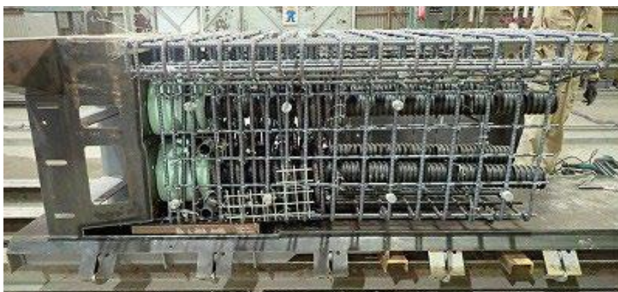
写真-3 試験体の配筋状況
