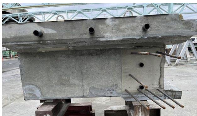
写真-4 過密配筋部における充填状況
