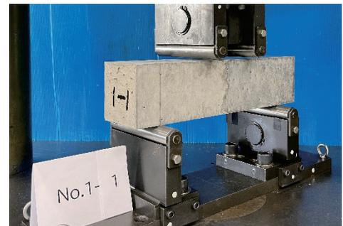
図-1 曲げ強度確認試験状況
