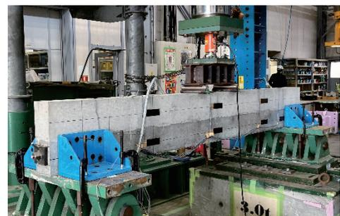
図-2 曲げ載荷試験状況
