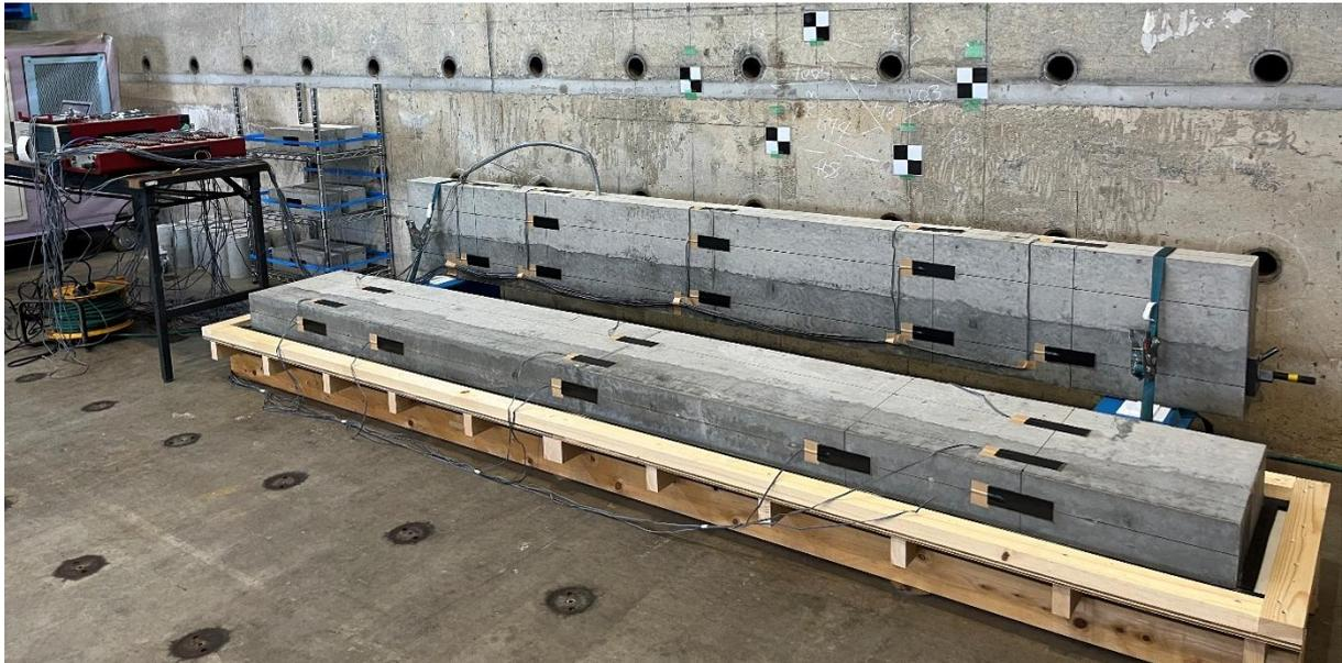
図-18 経時ひずみ変化量計測状況
