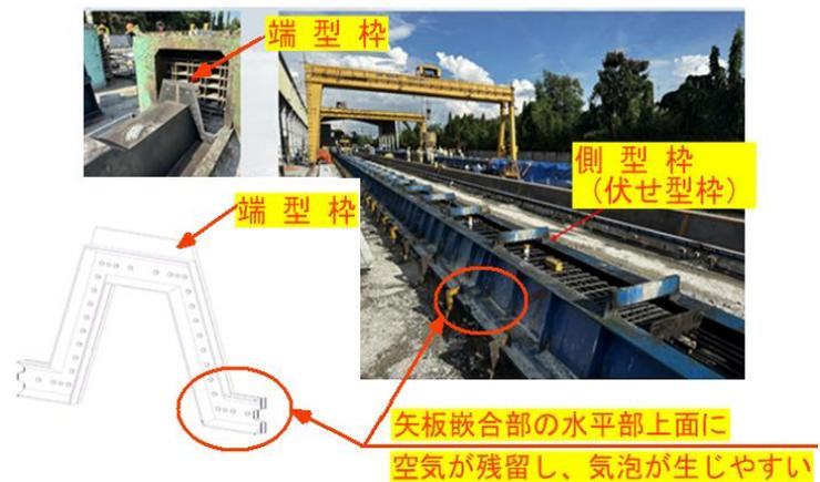
図-9 型枠構造
