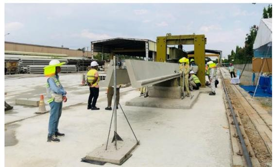
写真-29 曲げ耐力試験 実施状況
