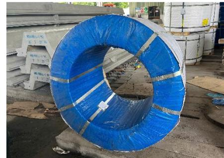
写真-8 PC 鋼より線
