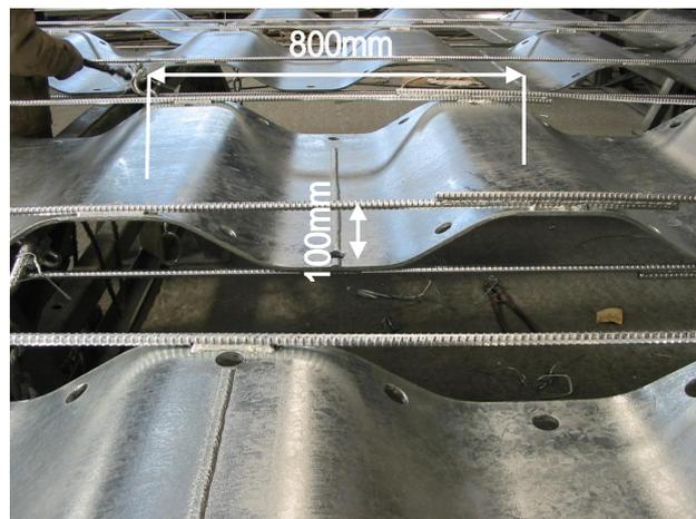
写真-2 波形鋼板形状図
