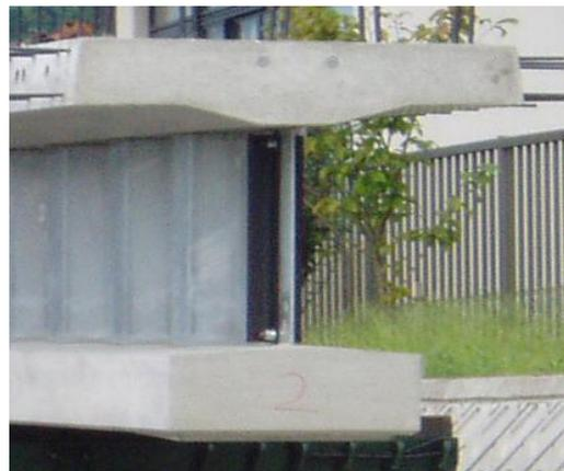
写真-17 支点部の補強
