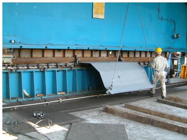
写真-3 鋼板の曲げ加工状況
