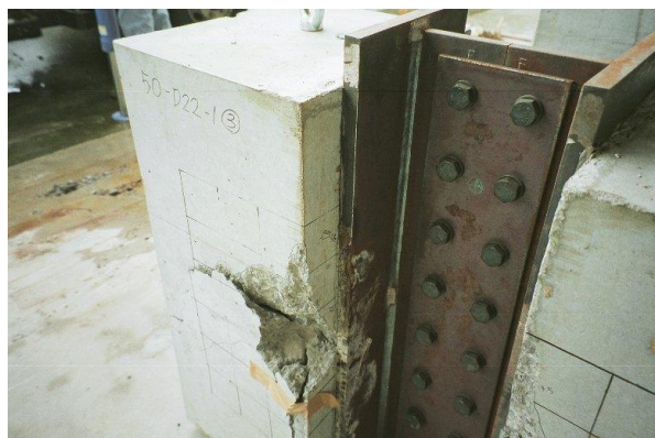
(c)50-D22-1 供試体破壊状況
