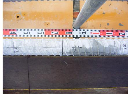
写真-30 頂部付近充填状況(W/C=44%)
