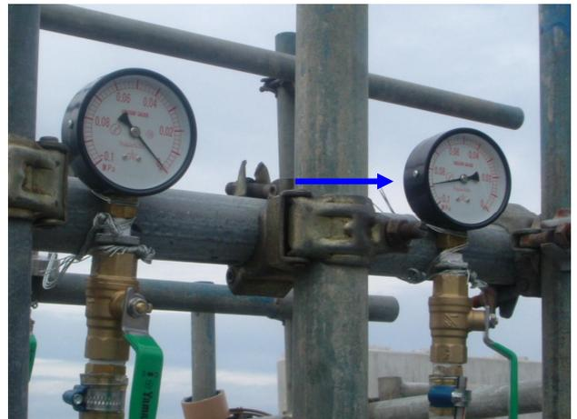
写真-22 注入側の負圧測定用圧力計
