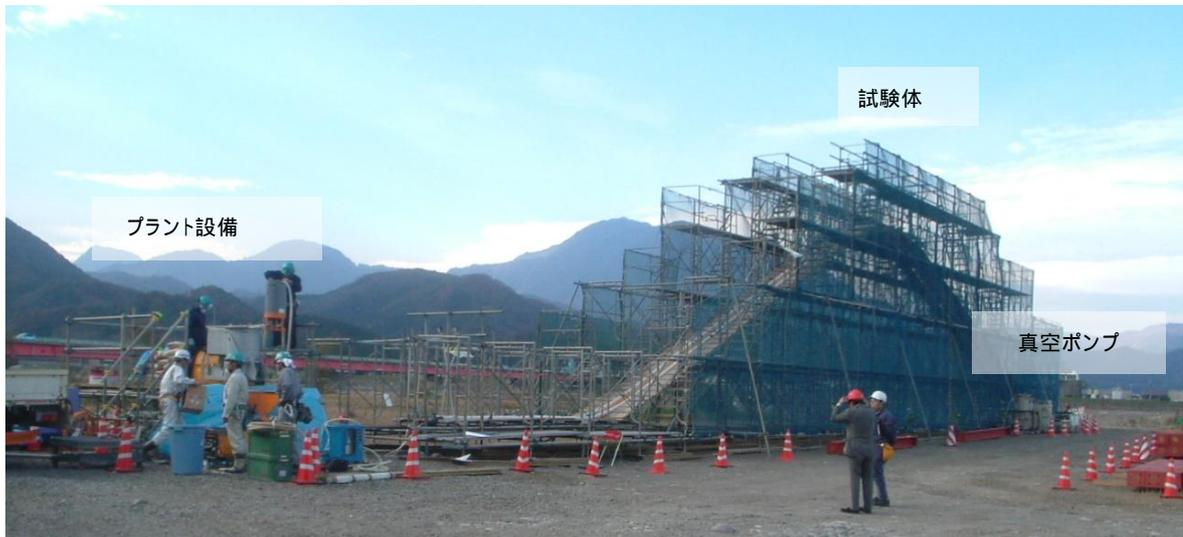
写真-18 グラウト試験体
