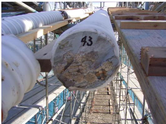
写真-33 断面充填状況(W/C=43%)
