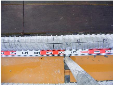
写真-29 頂部付近充填状況(W/C=43%)
