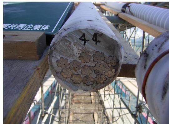
写真-34 断面充填状況(W/C=44%)
