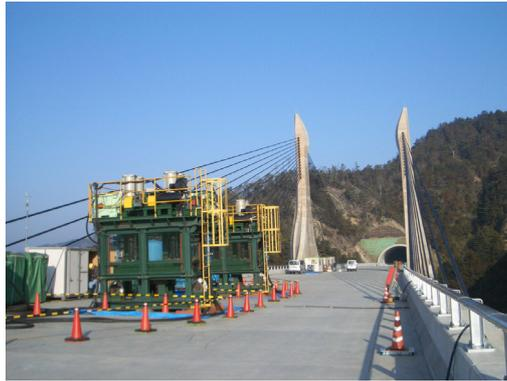
写真-4 起振機設置状況
