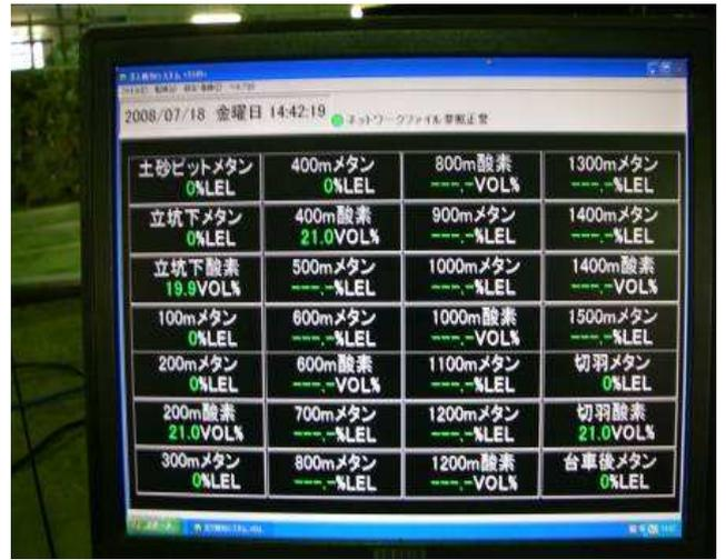
写真-9 立坑入口 測定表示
