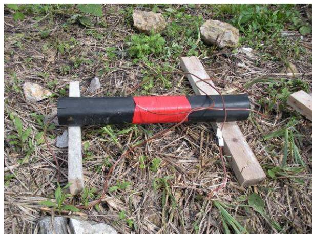
写真-3 温度測定用ダミーケーブル
