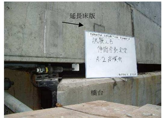
写真-7 伸縮挙動の計測状況
