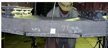
写真-3 曲げ変形性能確認予備試験
