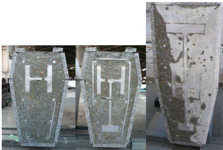
写真-4 試験体切断面
