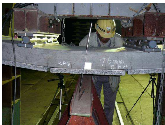
写真－７ 石材とコンクリートの離間(No.③)
