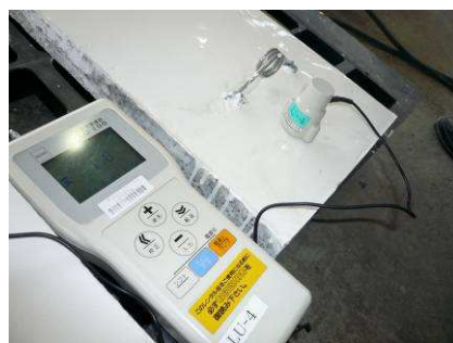
膜厚計による裏面処理厚管理
