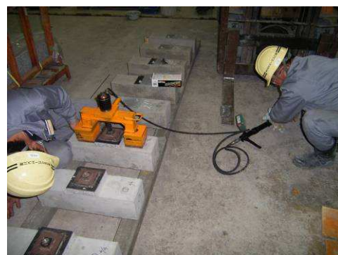
写真-10 引張試験状況
