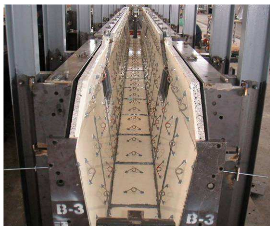
写真-13 石材配置状況
