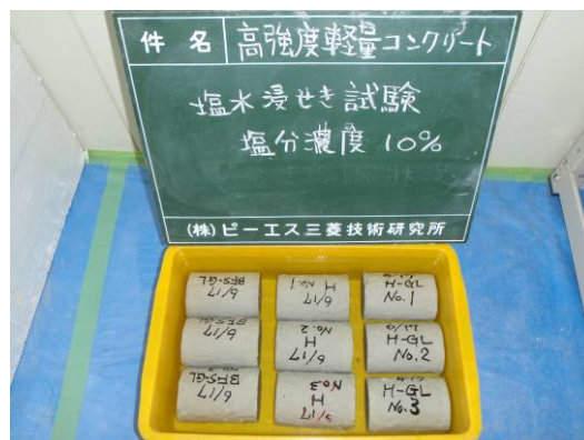
写真-1 塩水浸せき状況
