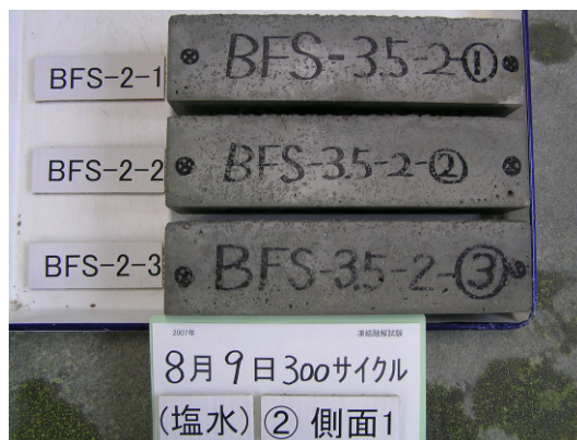
写真-3 凍結融解 300 サイクル後の供試体状況：BFS-GL
