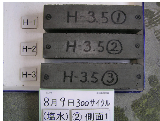
写真-2 凍結融解 300 サイクル後の供試体状況：H-GL
