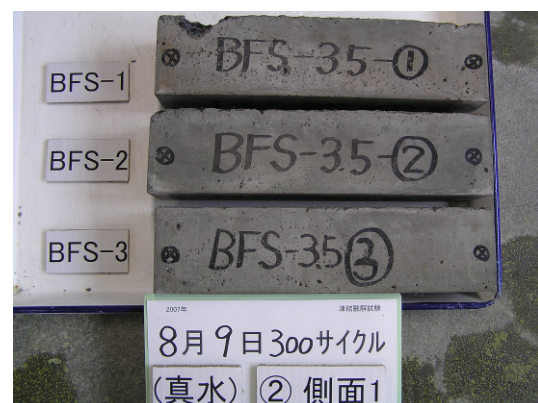
写真-3 凍結融解 300 サイクル後の供試体状況：BFS-GL
