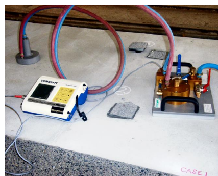
写真-2 透気試験状況
