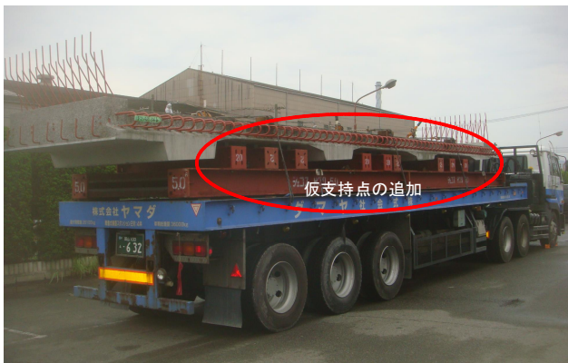
写真-3 運搬状況
