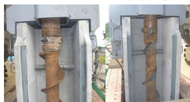
写真-3 貫通ピンの干渉
