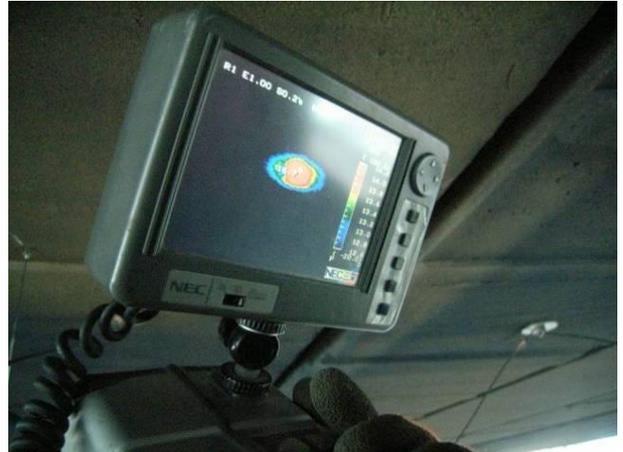
写真-3 赤外線探査状況(短絡箇所)
