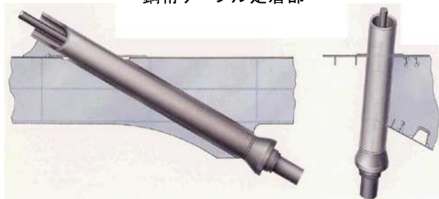
鋼桁ケーブル定着部
